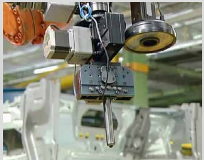
In-line spot weld testing « Cyclops »
